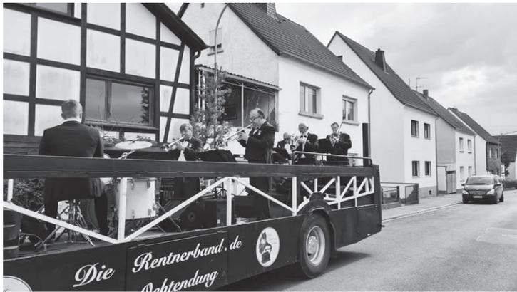
Der Kraftomnibus von Daimler Benz, Typ 0305, Erstzulassung 04.07.1974, wurde im Jahre 1996 erworben und auf einem Betriebsgelände in der Saffiger Straße umgebaut. Es sollte ein Cabrio werden. Nicht so einfach. Die Hülle des Busses ist Bestandteil der Konstruktion und dient der Stabilität. Mit Unterstützung des TÜVs gelang das Vorhaben. Der Bus wurde auf den Namen „Eiserner Gustav“ getauft.
